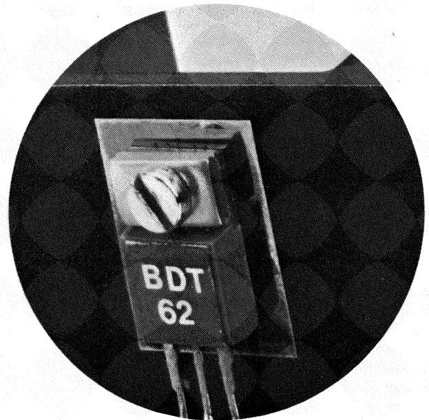
Prototipo di laboratorio dell'amplificatore Hi-Fi di potenza da 25/30 W realizzato con i Darlingtton BDT 62/63 in contenitore TO-220
